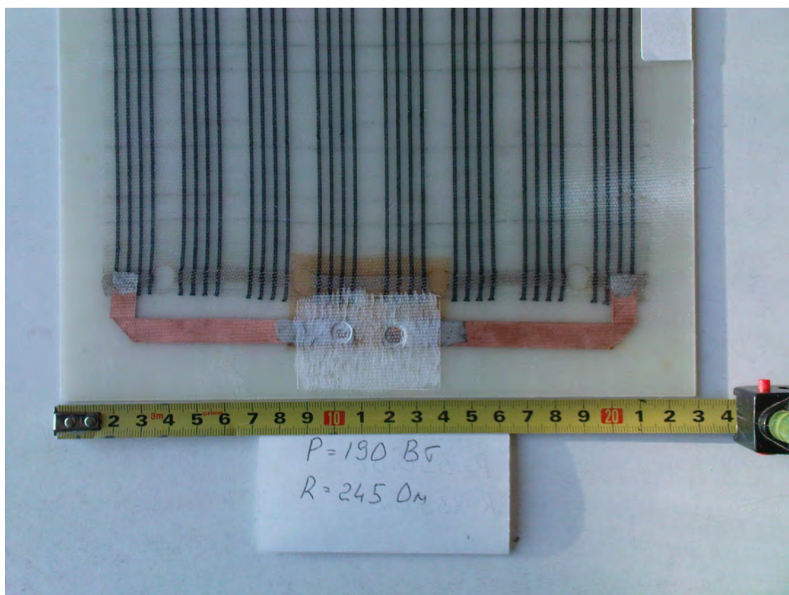
Фото 10 Тонкостенный стеклопластиковый электронагревательный элемент обогревателя СТЭН-190.400x230x41/220.50. Контактная площадка.
