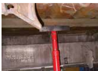
Выправка центрального ребра жесткости люка
