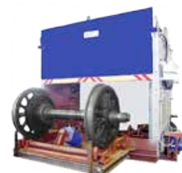
Оборудование для мойки колес и деталей вагонов
